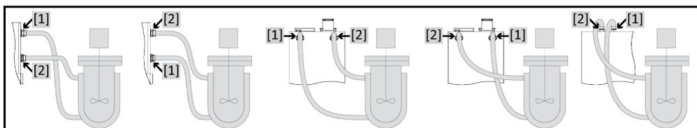
Pour l'exploitation correcte de l'application, sans bulles d'air dans le système, veiller à relier le raccord **>sortie fluide caloporteur<** [1] sortant du thermorégulateur, au point de raccord inférieur de l'application et le raccord **>entrée fluide caloporteur<** [2], menant au thermorégulateur, au point de raccord supérieur de l'application.
