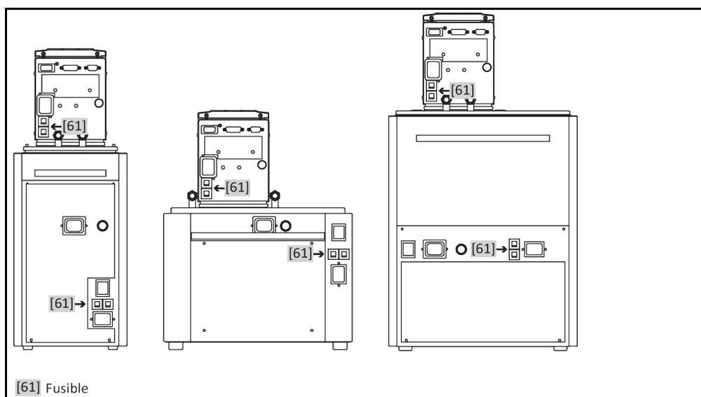
Les disjoncteurs de surintensité thermique, permettant une coupure intégrale (L et N), se trouvent sur la partie arrière. En cas d'erreur (aucune fonction et/ou aucun affichage), vérifier tout d'abord si les disjoncteurs de surintensité se sont déclenchés. Au cas où les disjoncteurs de surintensité se déclencheraient immédiatement après l'inversion, débrancher la fiche du secteur et se mettre immédiatement en rapport avec le service client. → page 95, section »Coordonnées«.
