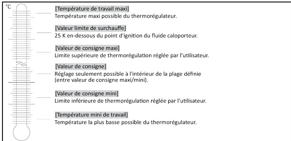
Le type et le fonctionnement de la fonction de protection contre la surchauffe et de la protection de niveau minimum dépendent du type de thermostat.
