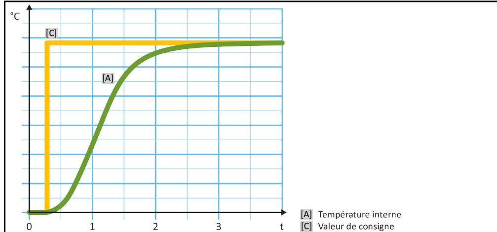
Régulation de température interne, dynamique avec dépassements possibles de la température
