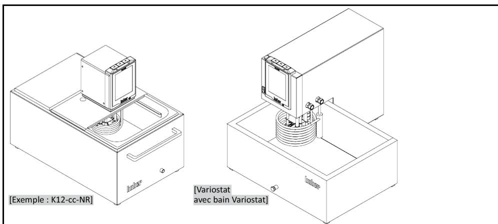
Observer le refoulement de volume s'effectuant dans un échantillon (p. ex. fiole d'Erlenmeyer). Placer la fiole dans le bain encore vide. Remplir tout d'abord une quantité suffisante de fluide caloporteur. Observer également que lors du retrait de l'échantillon, le niveau de liquide baisse. Lorsque la thermorégulation est activée, ceci peut être à l'origine d'une coupure de sécurité (protection de niveau minimum). Désactiver par conséquent la thermorégulation au préalable.
