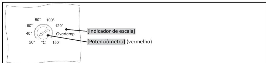
Uma proteção contra superaquecimento somente está integrada em termostatos que estejam equipados com um aquecimento. A monitoração da temperatura de entrada é uma funcionalidade de segurança de sua instalação. Esta é ativada imediatamente após a instalação ter sido abastecida com o termofluido.
