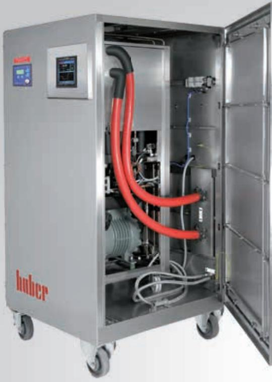
Durch die Beaufschlagung des Überlagerungsgases entsteht im Gehäuse ein Überdruck. Damit kann das Eindringen eines explosionsfähigen Gasgemisches verhindert werden.
